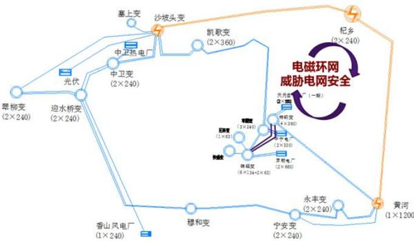
图 5.9 中宁工业园能源互联网规划电磁环网示意
